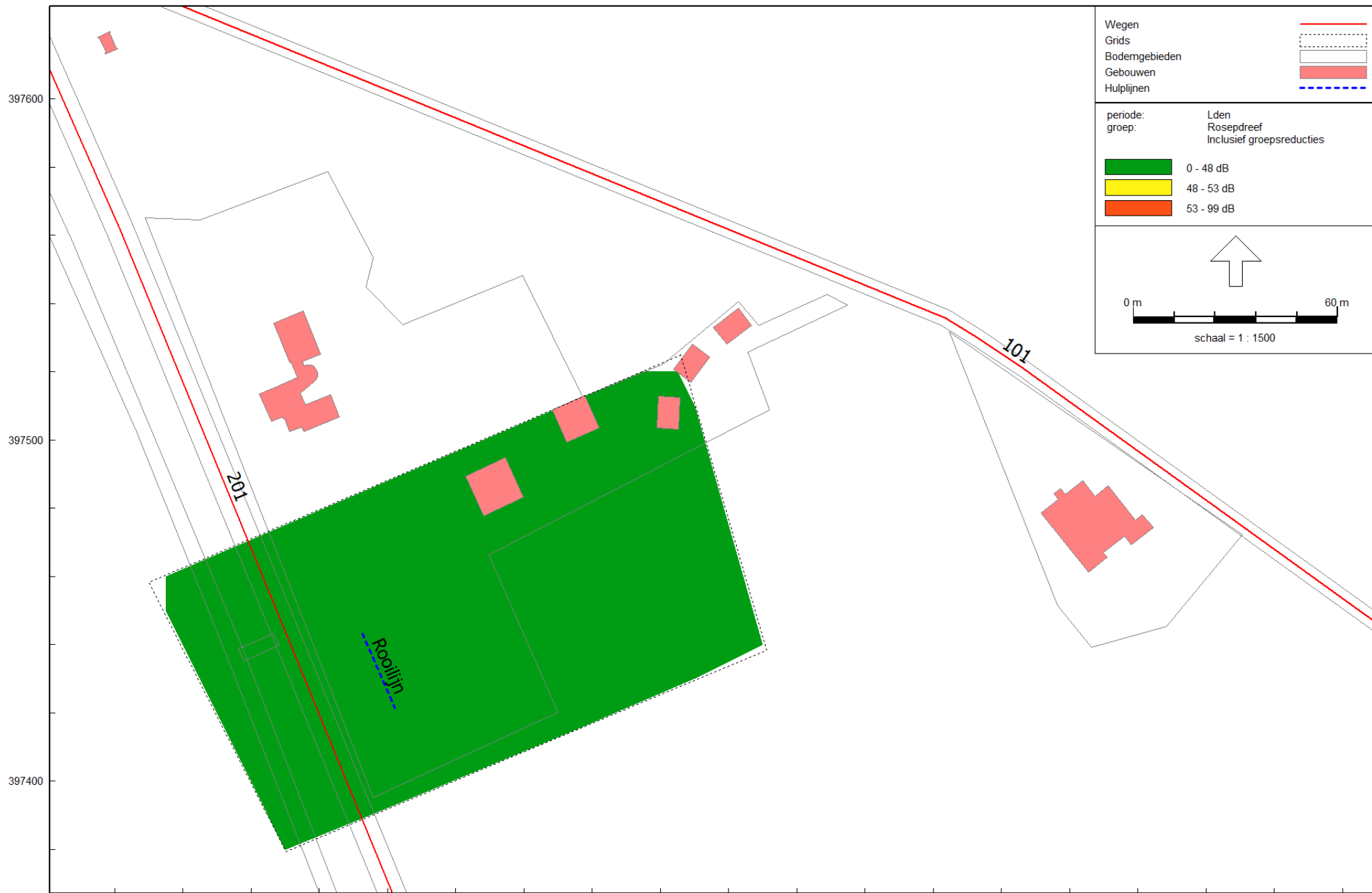
Figuur 5 Geluidscontouren vanwege wegverkeer op de Rosepdreef inclusief 5 dB correctie conform artikel 110g Wgh Beoordelingshoogte 1,5 / 4,5 en 7,5 meter
