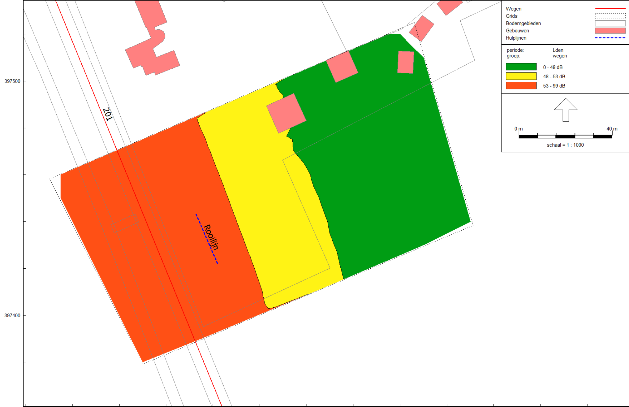
Figuur 6 Gecumuleerde geluidscontouren vanwege wegverkeer op de wegen exclusief 5 dB correctie conform artikel 110g Wgh Beoordelingshoogte 1,5 meter
