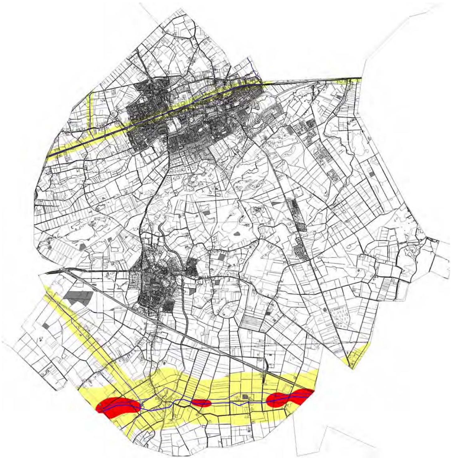
Figuur 4: PR 10 -6 contouren van de hogedruk aardgasleidingen (rood). Het gele gebied betreft de invloedsgebieden van de hogedruk aardgasleidingen. In blauw is de ligging van de leidingen aangegeven.
