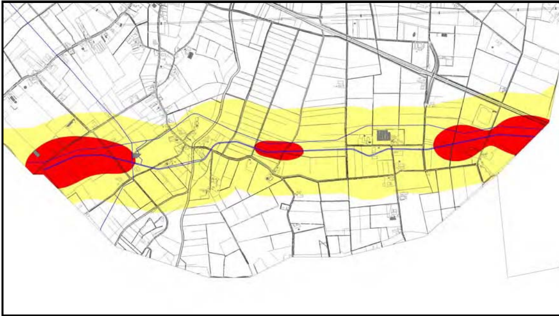
Figuur 5: PR 10 -6 contouren (rood) van de buisleiding A-525. Het gele gebied betreft het invloedsgebied van buisleiding A-525.
