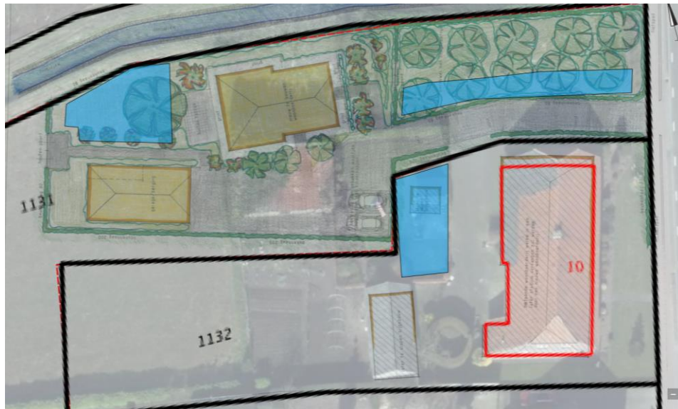
Afbeelding 12: inrichtingsplan inclusief waterretentiemaatregelen (in blauw)
