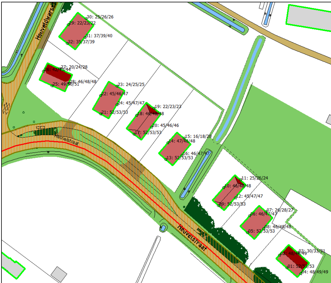
Figuur 4.2 Toetsingswaarde ( L_{den} ) in dB, door verkeer op de Heuvelstraat, incl. corr. cf. art. 3.4 RMG 2012.
