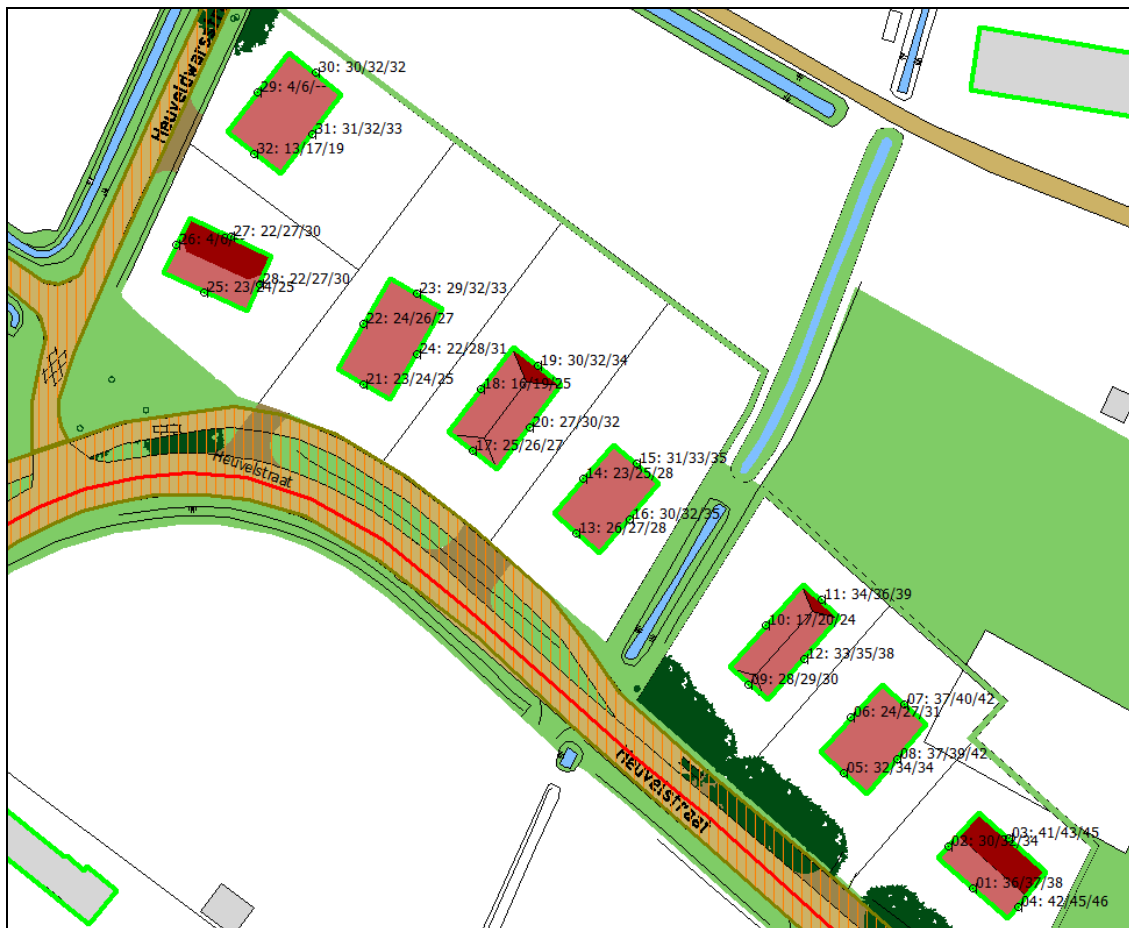
Figuur 4.3 Toetsingswaarde ( L_{den} ) in dB, door verkeer op de Vinkenberg, incl. corr. cf. art. 3.4 RMG 2012.
