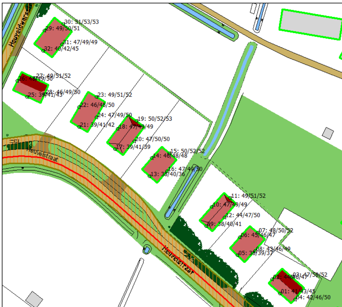
Figuur 4.1 Toetsingswaarde ( L_{den} ) in dB, door verkeer op de A58, incl. corr. cf. art. 3.4 RMG 2012.
