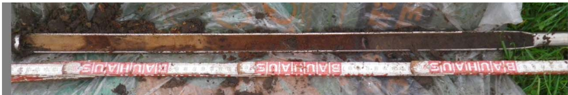
Afbeelding 4: Delen van gutsboringen met de overgang van het bouwlanddek naar het natuurlijke zandpakket, van boven naar beneden: boring 10, 11, 13, en 15.
