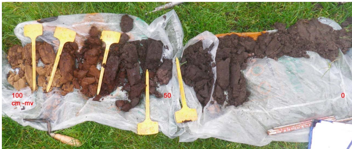
Afbeelding 3: De uitgelegde boring 12, van rechts naar links. De gele stokjes zijn 25 cm lang.
