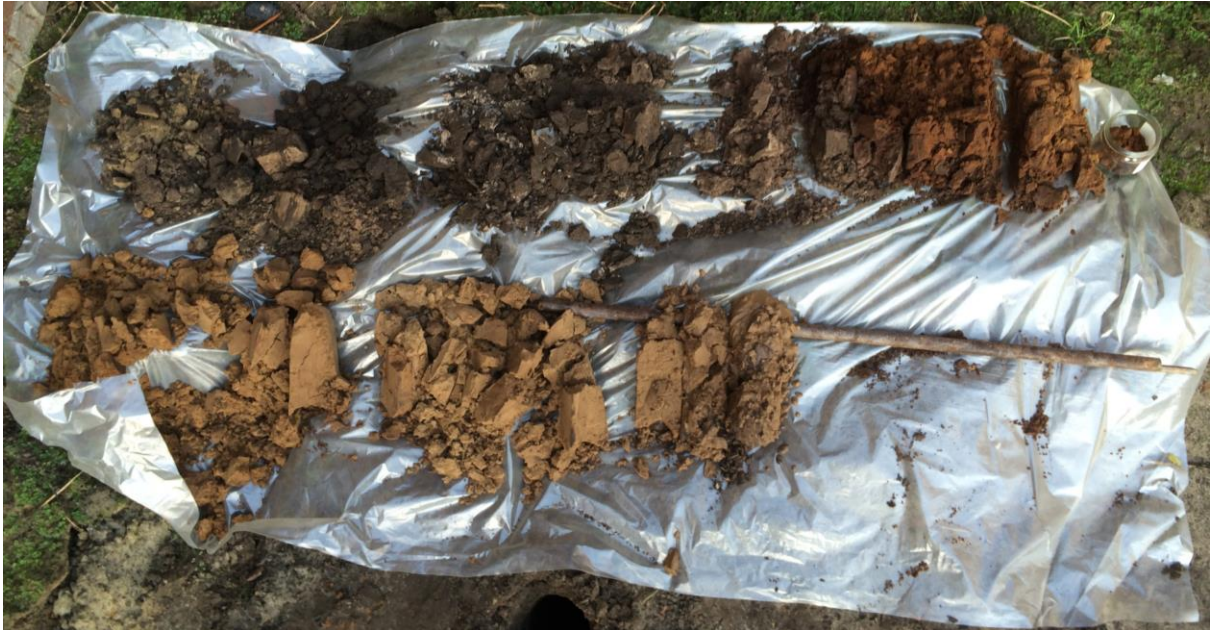
Opname van boring 6. In de top van het pleistocene zand is een inspoelingslaag (B-horizont) aanwezig.
