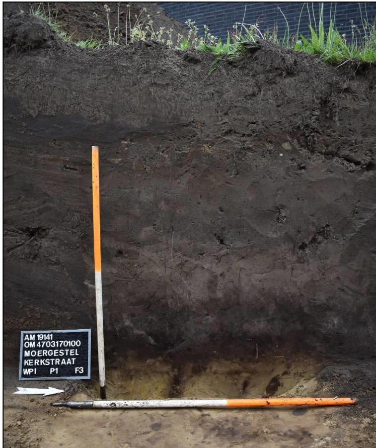
Figuur 3: Zicht op profiel 1.1. met onder het antropogeen opgebrachte pakket een podzolprofiel.
