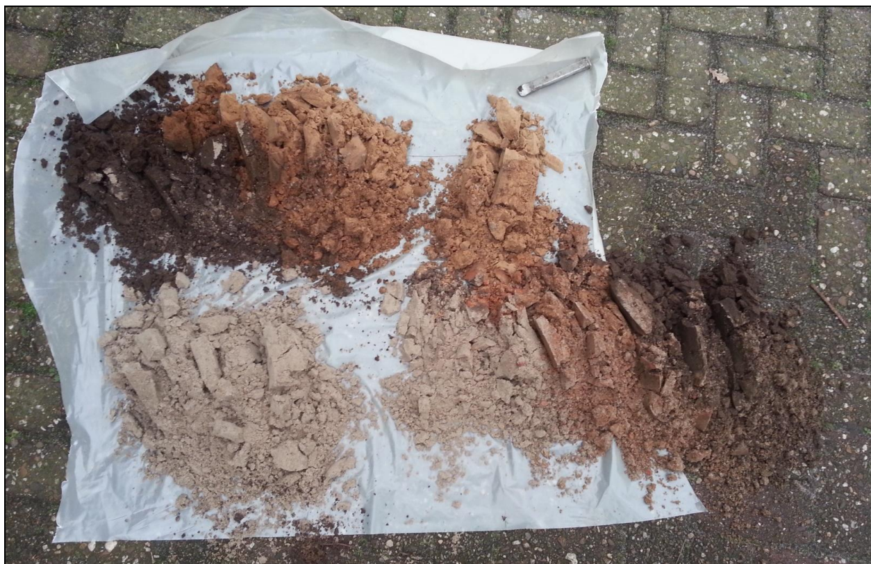
Figuur 7: Zicht op boring 6, uitgelegd van linksonder naar linksboven (0-175 cm –mv).
