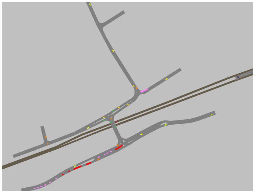
Figuur 6: Beeld uit de microsimulatie van de maximale wachtrij op de Blokshekken/Hoogstraat op een moment dat de spoorwegovergang net weer open is. In kleur zijn de snelheden van het verkeer aangegeven waarbij roze 0-10 km/uur is en rood 10-20 km/uur is.
