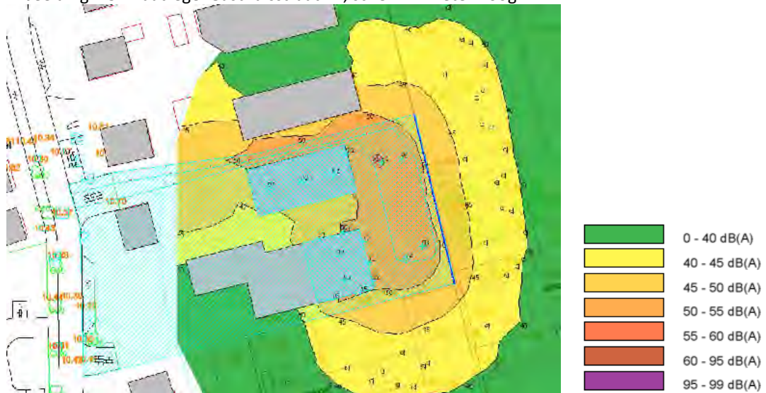
Afbeelding 4.5 Maatregel Gasthuisstraat 14, scherm 2 meter hoog
