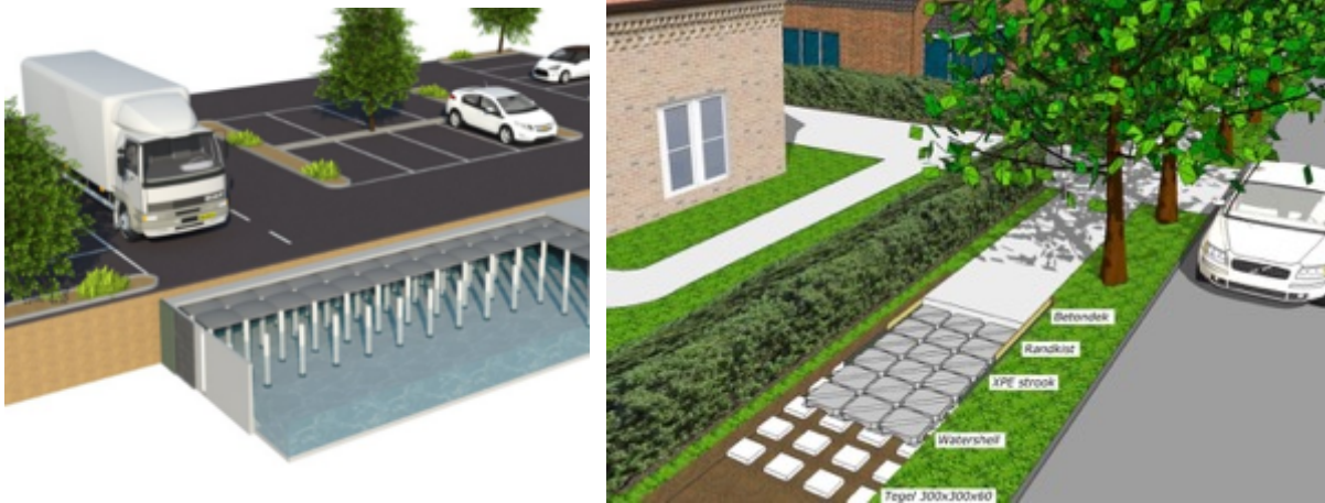
Figuur 11: Voorbeelden gebruik watershells voor infiltratie in bodem en als dichte kelder
