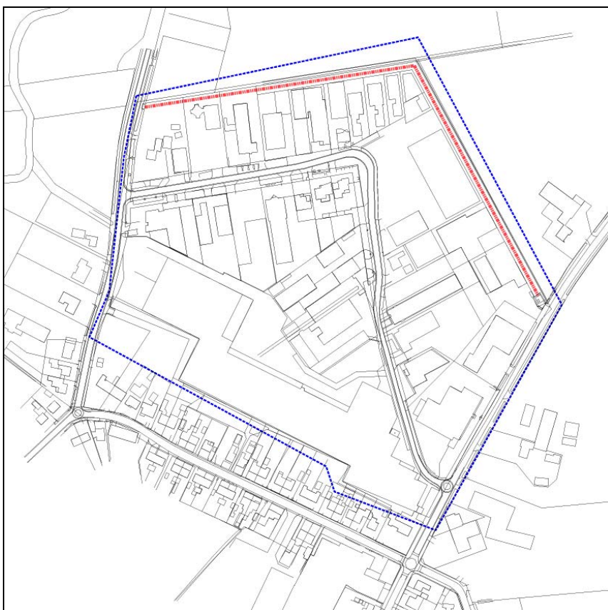
Tracé rioolpersleiding bedrijventerrein Steenfort
