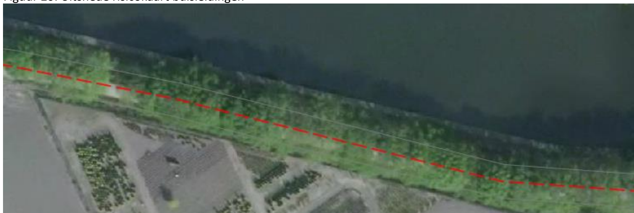
Figuur 21: risicoafstand 5 meter buisleidingen
