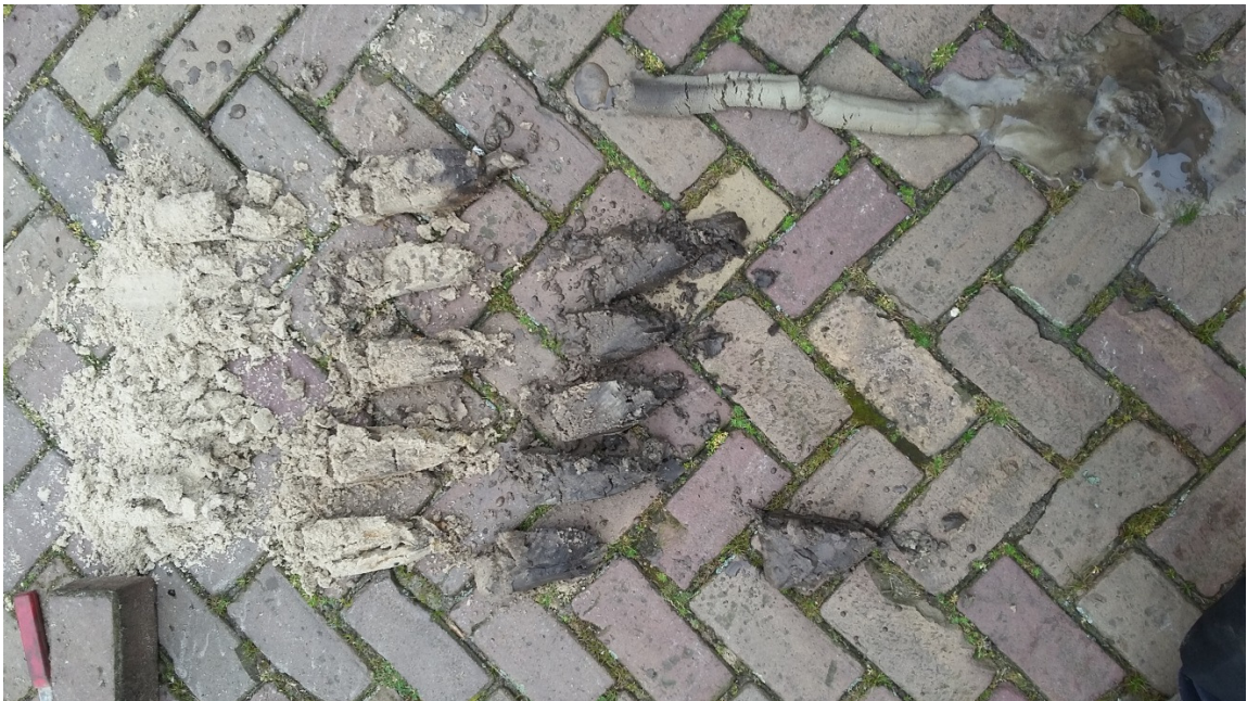
Afbeelding 3.2: bodemprofiel in boring 5 (Foto: Synthegra B.V.).
