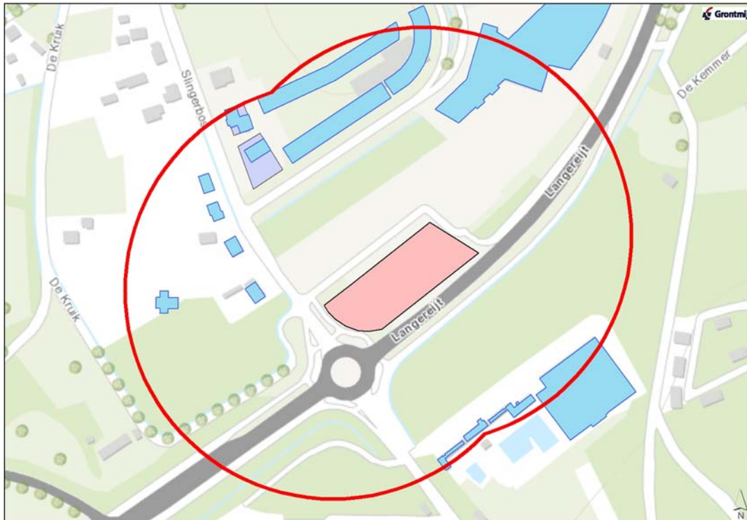
Figuur 4.1 De afstand tot de grens van het invloedsgebied geldt voor LPG tankstations vanaf het vulpunt voor LPG, het ondergrondse reservoir, gerekend vanaf de aansluitpunten van de leidingen alsmede het bovengrondse deel van de leidingen en de pomp bij het reservoir.
