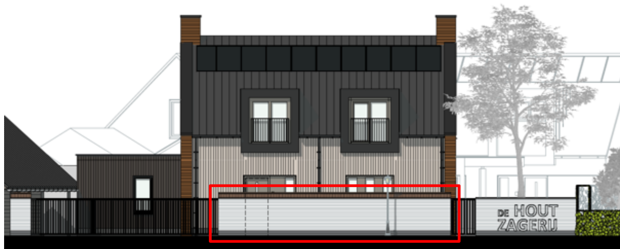
Aanzicht van de muur met in rood omlijnd het reeds bestaande deel.
