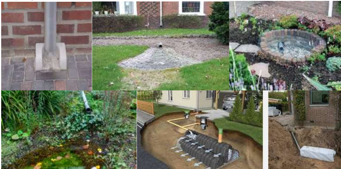
Voorbeelden van infiltratiemogelijkheden
