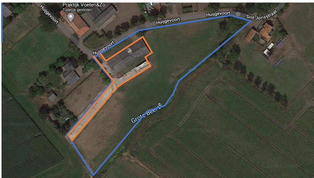
Afbeelding: met omljnd de totale planlocatie in blauw en te slopen bedrijfsgebouwen en pad in oranje
