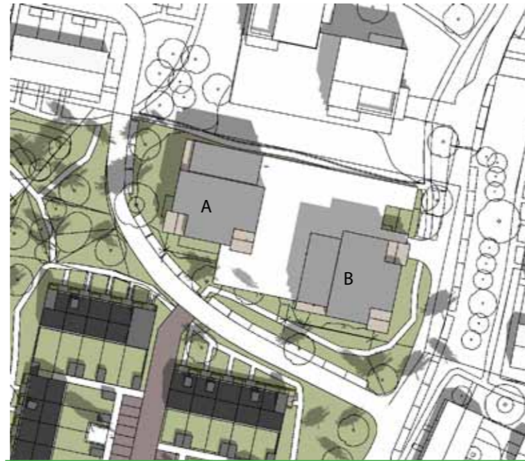
Zon vanaf ZZO conclusie - geen schaduw op bestaande appartementengebouw en dek door A en B
