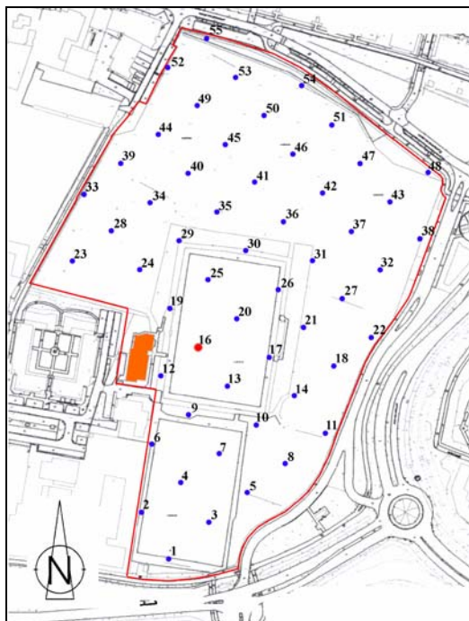
Afbeelding 10. Boorpuntenkaart AAI-1. Het plangebied is rood omkaderd. Aanwezige bebouwing (sportkantine/kleedruimtes) is oranje gemarkeerd. De boring (Boring nr. 16) waar rondom karterend booronderzoek is uitgevoerd, is rood gemarkeerd. Schaal 1: 5000. ©Topografische Dienst Kadaster, Emmen [2004].
