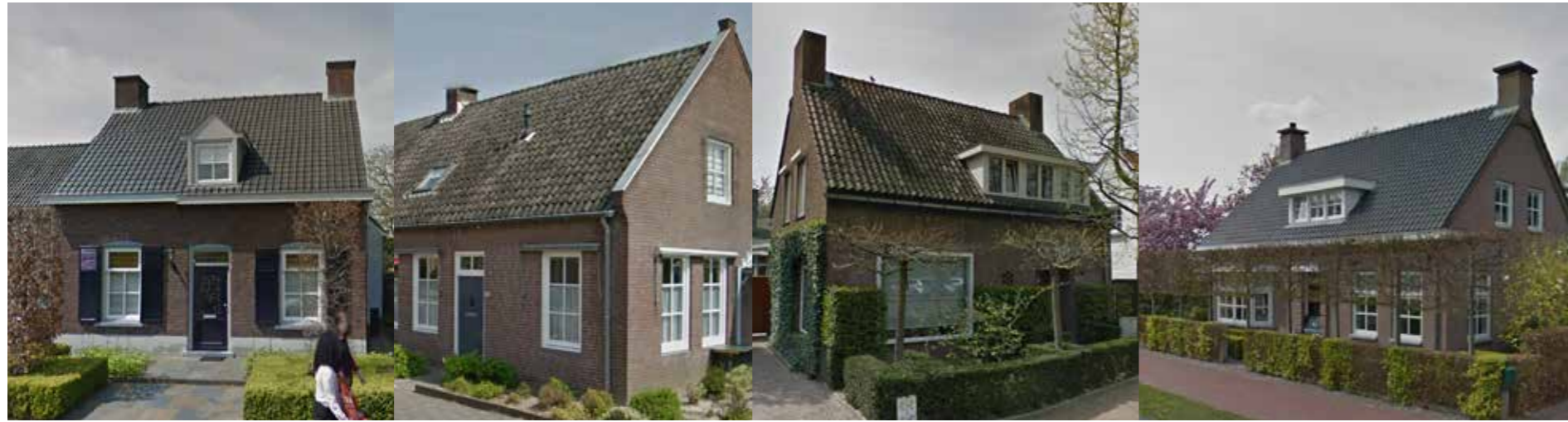
bestaande Nuenense lintbebouwing als uitgangspunt | 1,5 laag + kap | dakvlak parallel aan Ter Warden | massa passend in kleinschalig straatbeeld
