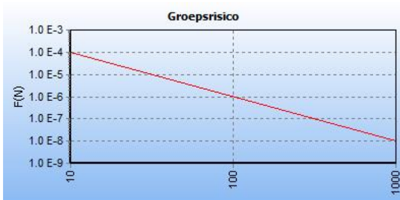
Afbeelding 8 fN-curve buisleiding A-665-deel-1, toekomstige situatie
