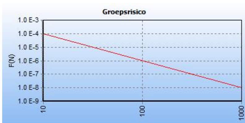
Afbeelding 6 fN-curve buisleiding A-665-deel-1, huidige situatie
