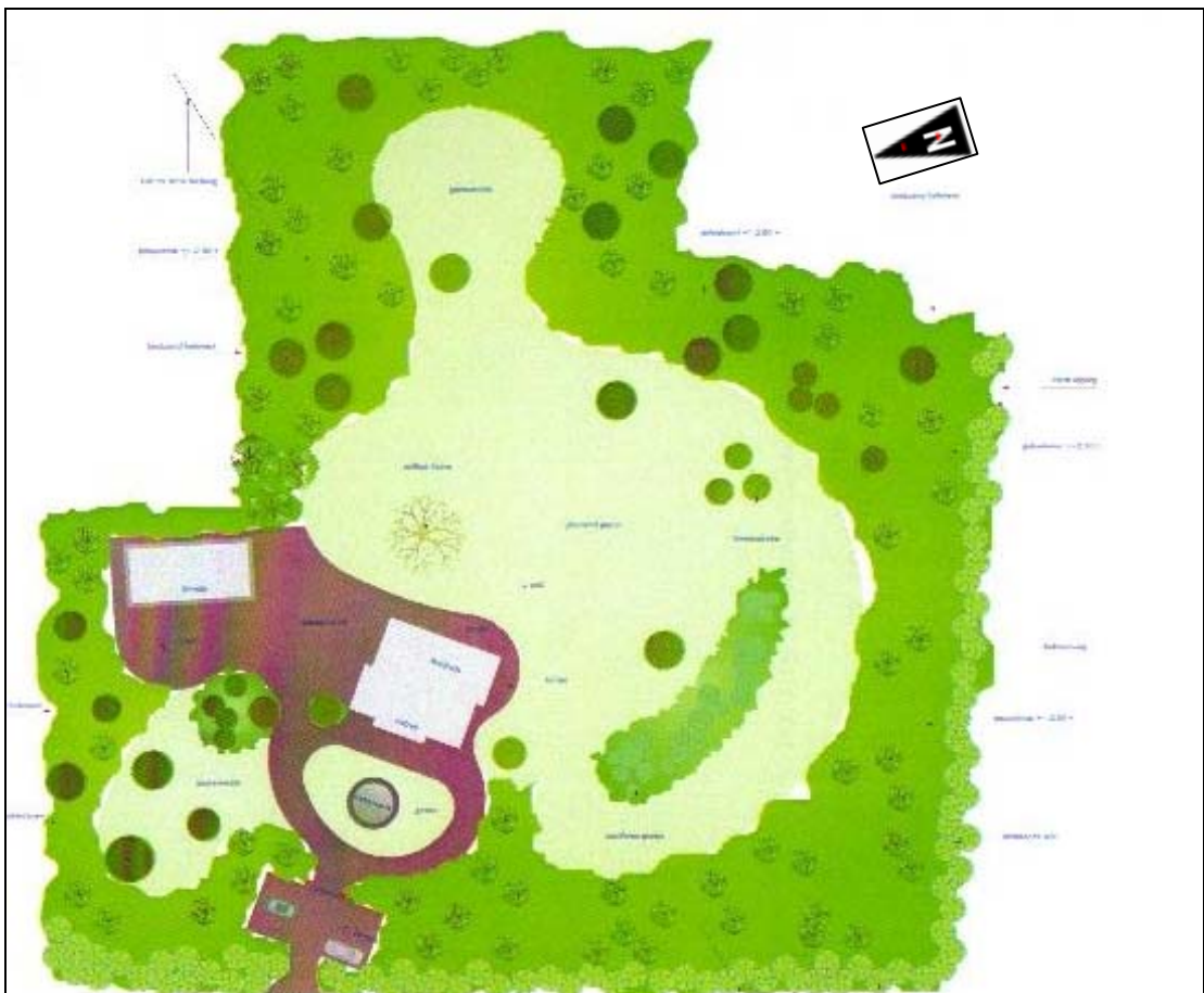
Figuur 1.1 Tekening nieuwe situatie plangebied Frederiksweg 45 te Mill. De rode zones zijn de toekomstige verhardingen voor toegangsweg en parkeerplekken, de witte blokken geven de nieuwe gebouwen weer. De lichtgroene zones wordt ingericht met tuin (gazon), de groene zones met bos (Bron: architect opdrachtgever, 2010).
