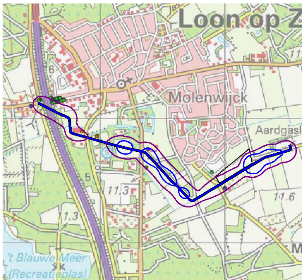
Figuur 4 PR-contouren van de leiding Loon op Zand – Waalwijk. Binnen de paarse contouren is het PR groter dan 10^{-8} per jaar; binnen de blauwe contouren is het PR groter dan 10^{-7} per jaar; het PR is overall kleiner dan 10^{-6} per jaar.
