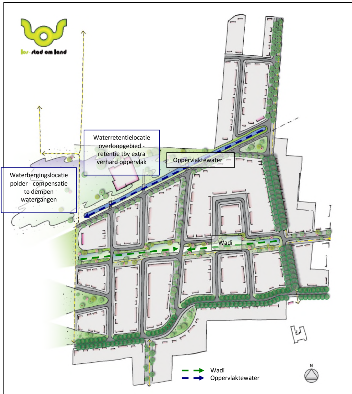
Figuur 4.2 schetsmatige weergave principe watersysteem Sweensstraat-West
