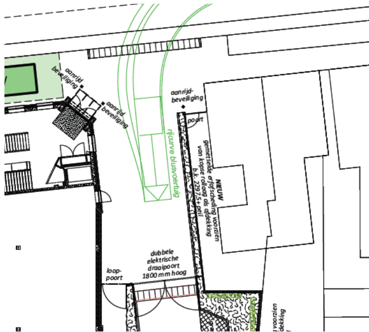
Figuur 3.2 uitsnede nabij inrit Gasthuisstraat met afscheiding naast Gasthuisstraat 128. De inrit is niet bedoeld voor vrachtverkeer, maar zo ontworpen dat een blusvoertuig indien nodig hier wel naar binnen kan.
