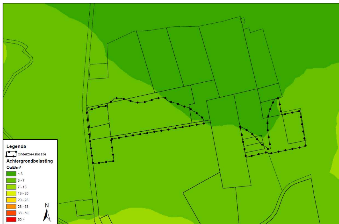
Figuur 16: Rekenresultaten achtergrondbelasting
