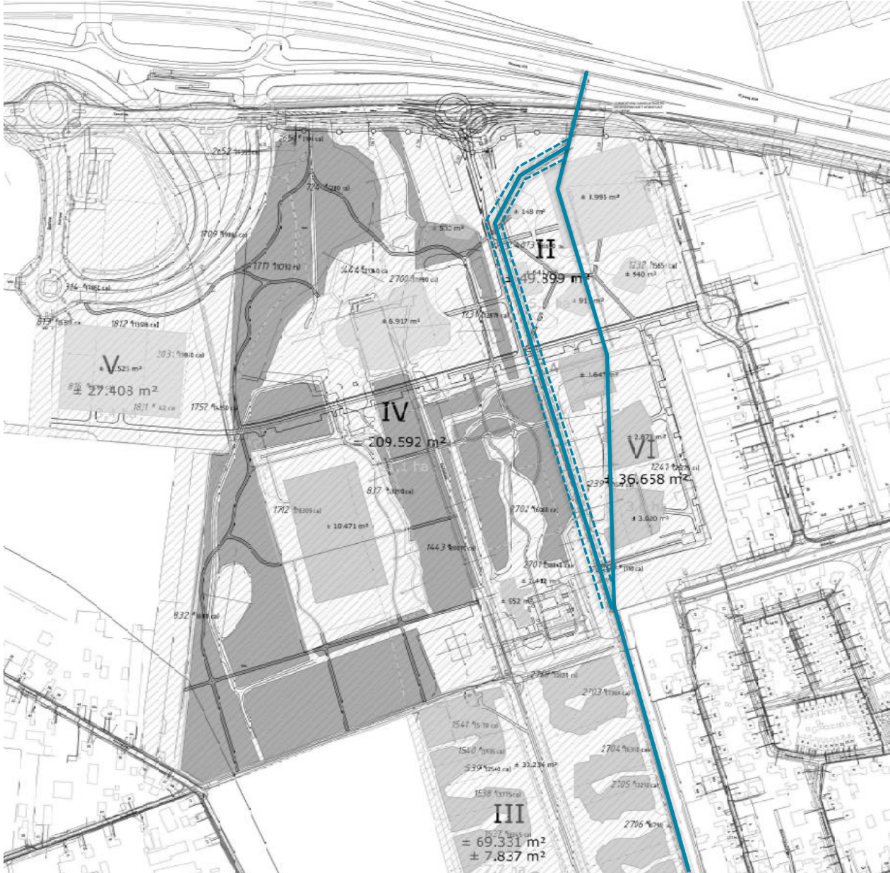
Figuur 4-5 Ligging bestaand tracé en voorgesteld tracé persleiding waterschap Aa en Maas (tekening 09-10-2017, gemeente Heusden)
