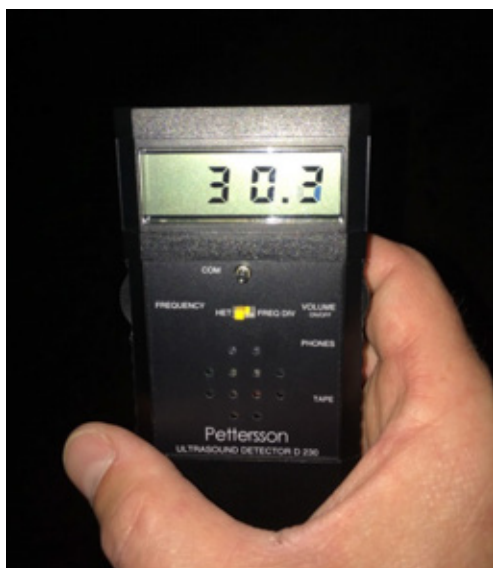
Figuur 25 Petterson D230 batdetector die is gebruikt voor het vaststellen van de aanwezigheid van vleermuizen. Foto: Fabrice Ottburg©.
