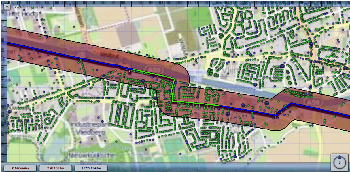
Figuur : Kilometer Leiding Z-517-12 (groen) waar het groepsrisico het hoogst is berekend. De rode contour hieromheen is het invloedsgebied van de leiding.
