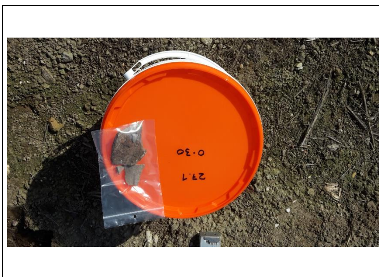
Foto 3: asbestverdacht materiaal in uitkomend materiaal proefsleuf 27 (22 augustus 2017)
