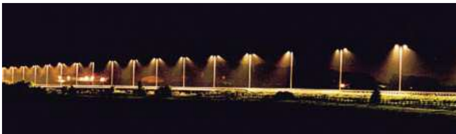
Figuur 4: Speciale lampen en lantaarns kunnen de uitstraling van licht naar de omgeving en daardoor tevens de verstoring sterk beperken (bron : Met Vleermuizen Overweg, Rijkswaterstaat, 2004)
