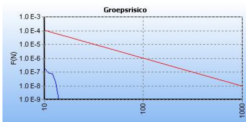
Figuur 5.1c fN-curve voor Z-517-04
