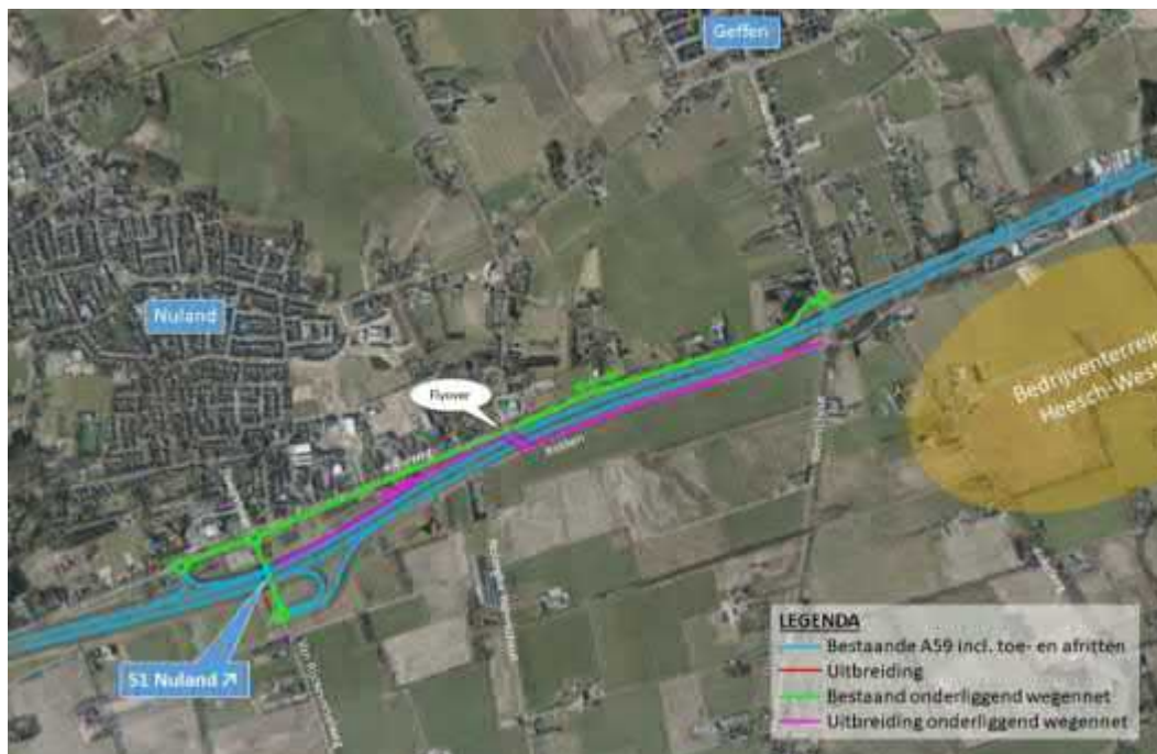
Figuur 3.9 Alternatief 2a Leefbaar Nuland voor aansluiting Rekken op aansluiting Nuland (bron: Gemeenschappelijke Regeling Heesch West, 2021)
