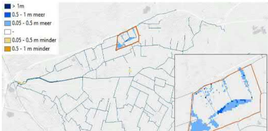
Figuur 16.2c Overstromingspatroon zomerbui met Heesch West (blauw=extra overstroming ten opzichte van referentiesituatie zonder Heesch West, oranje is minder overstroming ten opzichte van referentiesituatie (bron: RHDHV, 2020)
