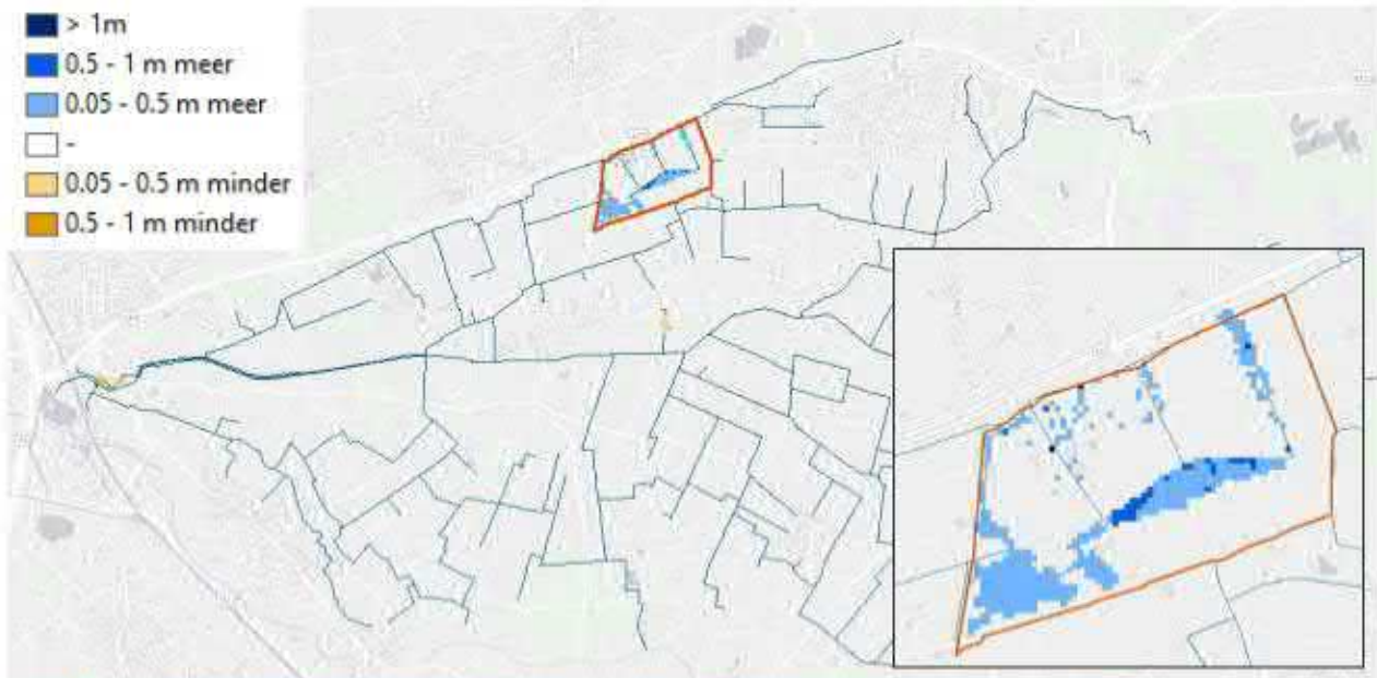
Figuur 3-8: Overstromingspatroon zomer situatie (blauw = extra overstroming en oranje minder t.o.v. referentie).
