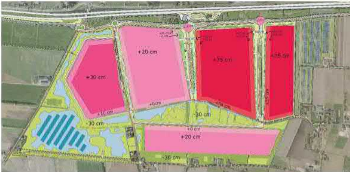
Figuur 3-3: Ophoging maaiveld bedrijventerrein Heesch West.
