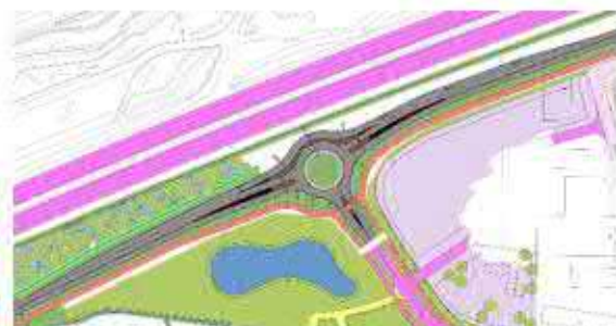
Figuur 5.6: Enkelstrooksrotonde met bypass oost-west
