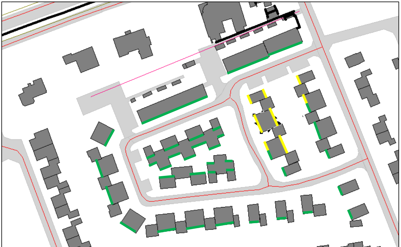
Figuur 5.3 overzicht geluidluwe gevels
