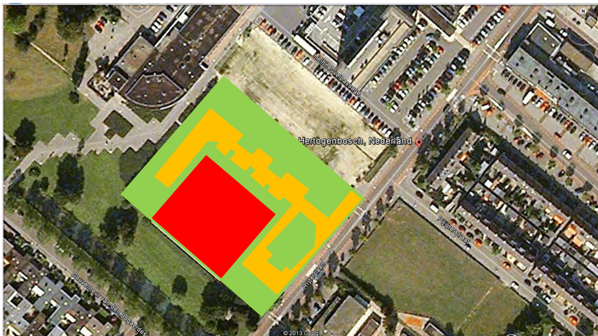
Figuur 1.2 Schematische weergave van de huidige terreinindeling. De terreinverharding is weergegeven in oranje, het dakoppervlak in rood en het onverhard oppervlak in groen.
