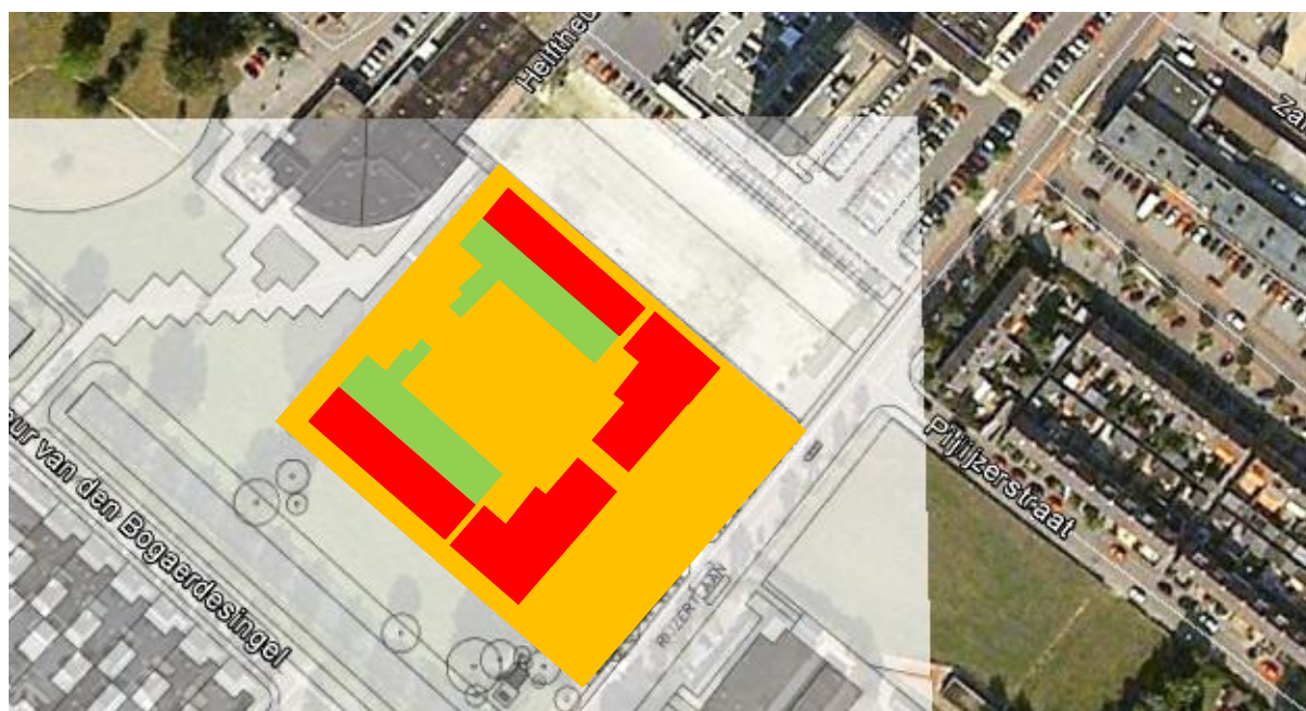
Figuur 1.3 Schematische weergave van de toekomstige terreinindeling. De terreinverharding is weergegeven in oranje, het dakoppervlak in rood en het onverhard oppervlak in groen.
