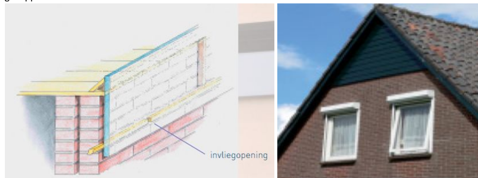
Figuur 5. Voorbeelden van geschikte gevelbetimmering (bron: Korsten & Limpens, Folder vlemuisvriendelijk bouwen).
