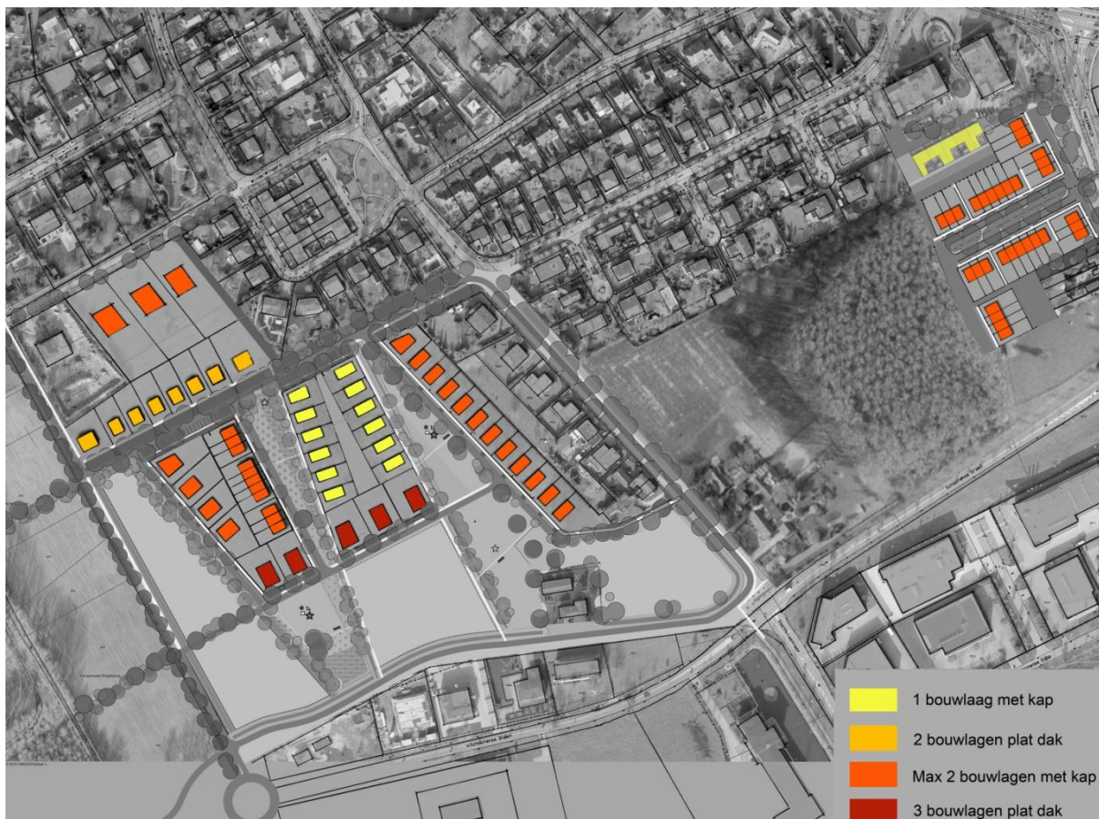
Figuur 11: Bebouwingshoogte en kapvorm
