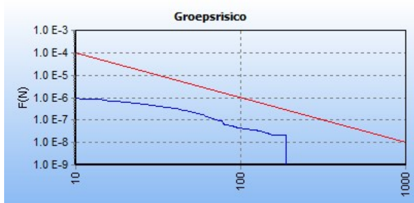
Figuur 4.4.3 FN-curve voor Z-540-44 voor de kilometer tussen stationing 150 en 1150.
