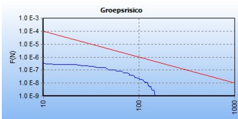
Figuur 4.2.3 FN-curve voor Z-540-01 voor de kilometer tussen stationing 63600 en 64600.
