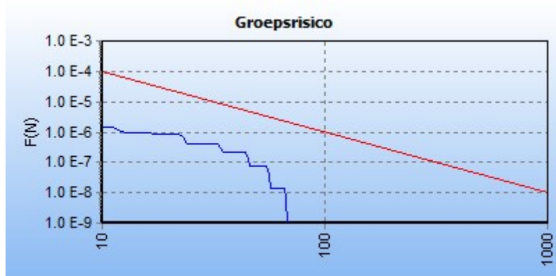
Figuur 4.3.3 FN-curve voor Z-540-13 voor de kilometer tussen stationing 0 en 1000.
