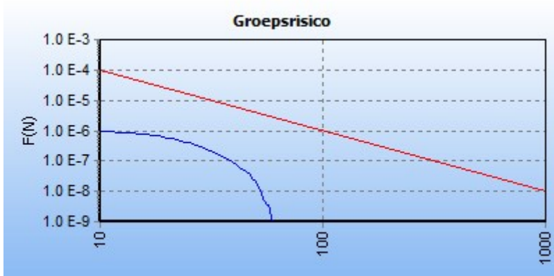
Figuur 4.1.3 FN-curve voor Z-514-15 voor de kilometer tussen stationing 1750 en 2750.
