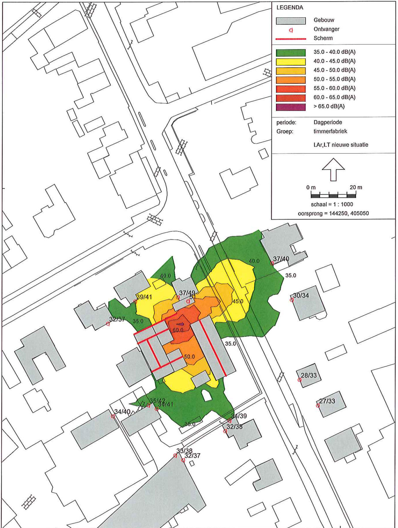
figuur 5.2: Overzicht rekenmodel met resultaten nieuwe toestand
