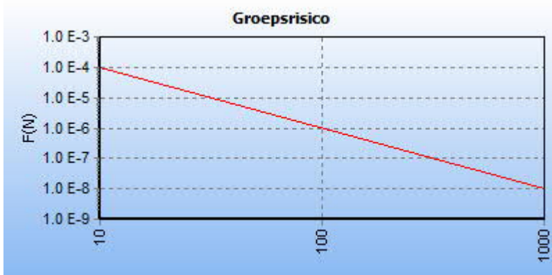
5.4 Figuur 5.4 FN curve voor 5962_leiding-A-665-deel-1 van N.V. Nederlandse Gasunie voor de kilometer tussen stationing 1080.00 en stationing 1340.00
