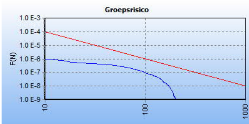
5.7 Figuur 5.7 FN curve voor 5962_leiding-Z-542-17-deel-1 van N.V. Nederlandse Gasunie voor de kilometer tussen stationing 0.00 en stationing 0.00
