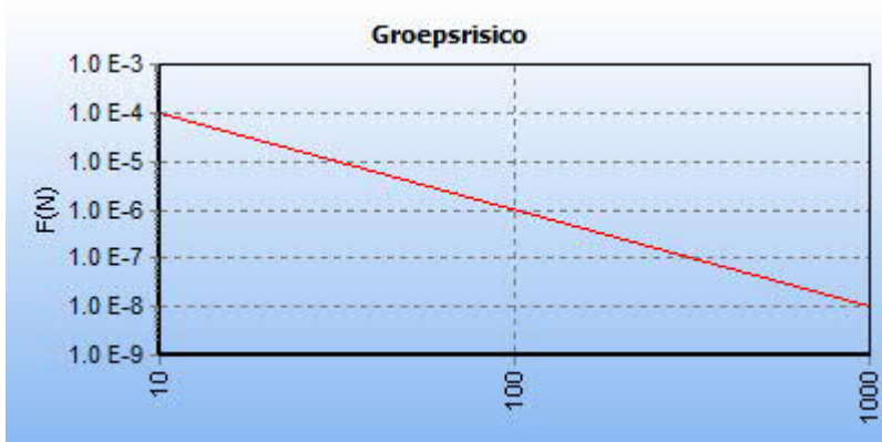
5.5 Figuur 5.5 FN curve voor 5962_leiding-N-576-75-deel-1_excl verl van N.V. Nederlandse Gasunie voor de kilometer tussen stationing 920.00 en stationing 1920.00
