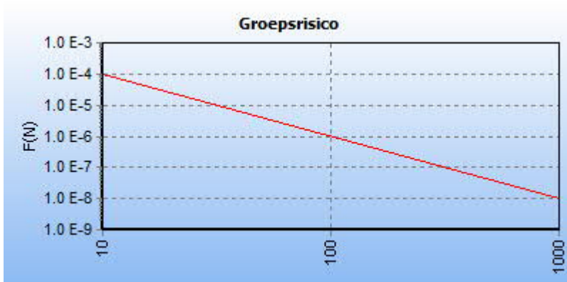
5.5 Figuur 5.5 FN curve voor 5962_leiding-N-576-75-deel-1_excl verl van N.V. Nederlandse Gasunie voor de kilometer tussen stationing 920.00 en stationing 1920.00
