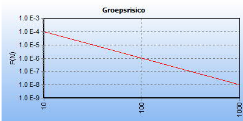
5.2 Figuur 5.2 FN curve voor 5962_leiding-A-578-deel-1 van N.V. Nederlandse Gasunie voor de kilometer tussen stationing 1050.00 en stationing 1340.00
