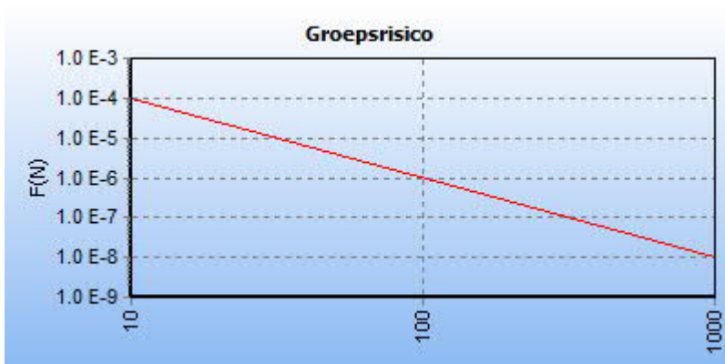
5.8 Figuur 5.8 FN curve voor 5965_leiding-N-576-75-deel-1_incl verl van N.V. Nederlandse Gasunie voor de kilometer tussen stationing 1880.00 en stationing 2880.00
