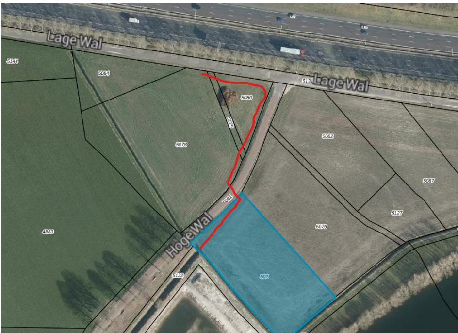
Figuur 4-8 Omlegroute A-watergang NL19-O5
