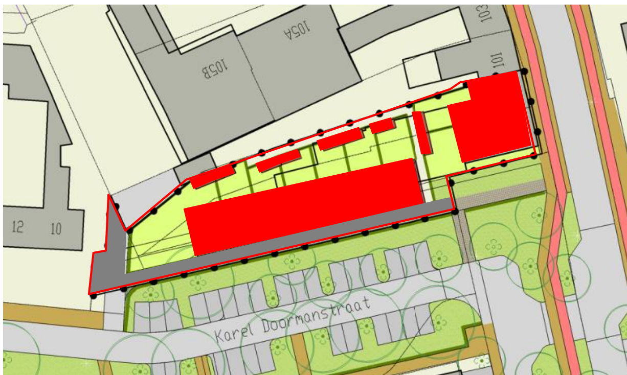
Figuur 1.3 Toekomstig verhard oppervlak (rood: dakoppervlak, grijs:terreinverharding)
