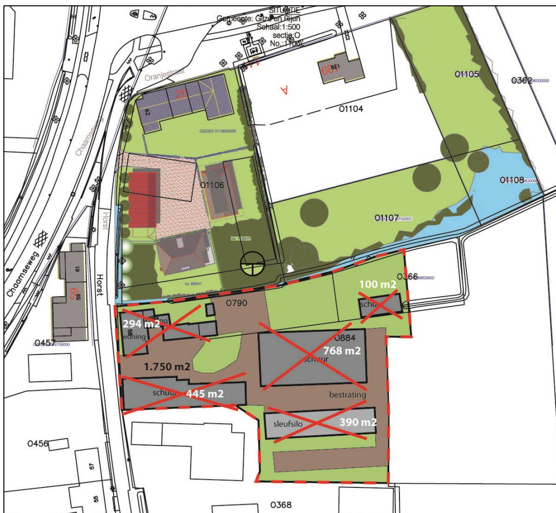
Te slopen bebouwing en verharding
