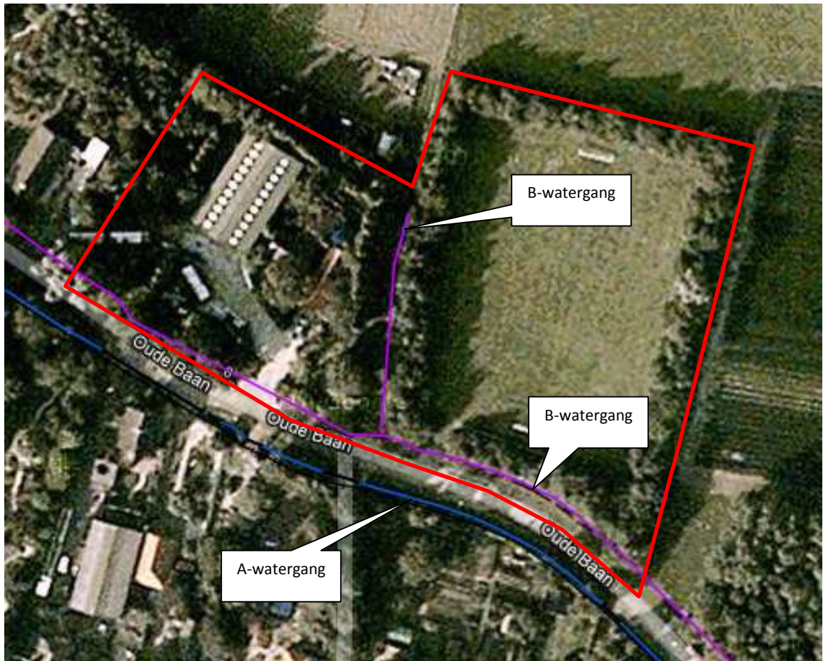
Figuur 4 Oppervlaktewater waterschap Brabantse Delta, blauw = waterloop categorie A paars = waterloop categorie B (bron: legger oppervlaktewater, waterschap Brabantse Delta)
