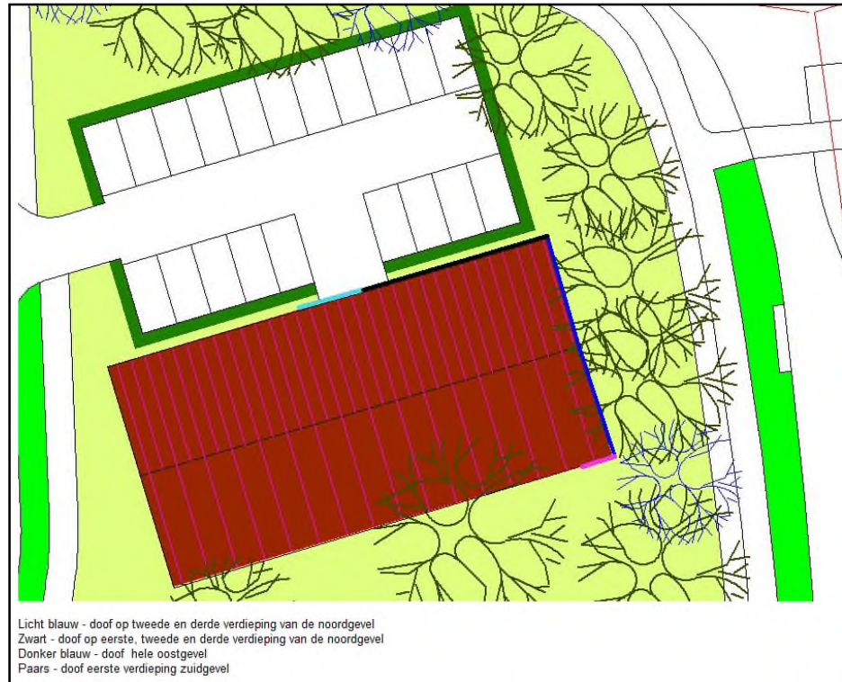
Afbeelding 17: te realiseren dove gevels gebouw D
