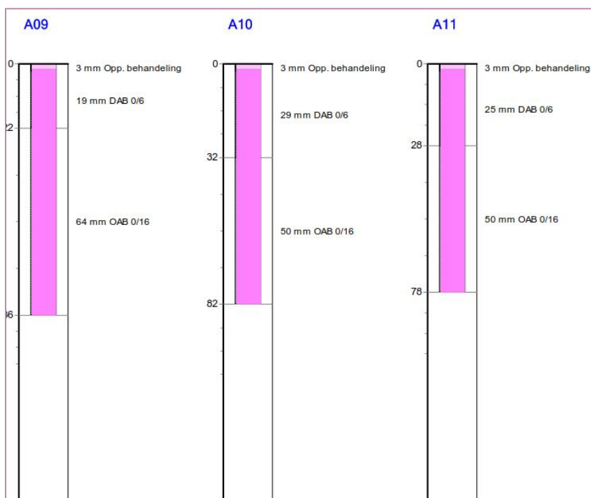
Figuur 3-8b Stationsplein, constructieopbouw asfaltkernen A 09 tot en met A 11
