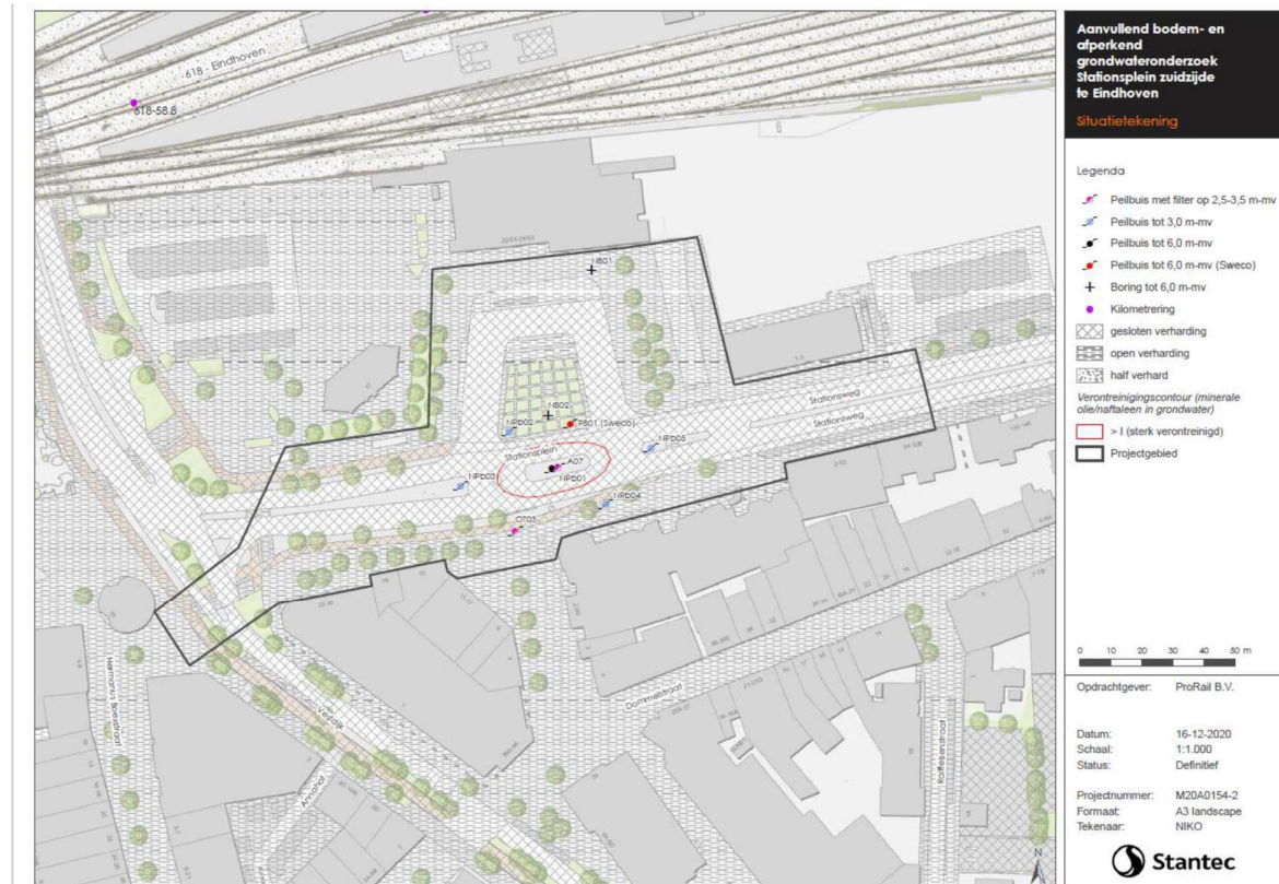
Figuur 6 Situatietekening met verontreinigingssituatie ter hoogte van peilbuis A07 (Bron: Onderzoek Stantec, M20A0154, d.d. 22 januari 2021)
